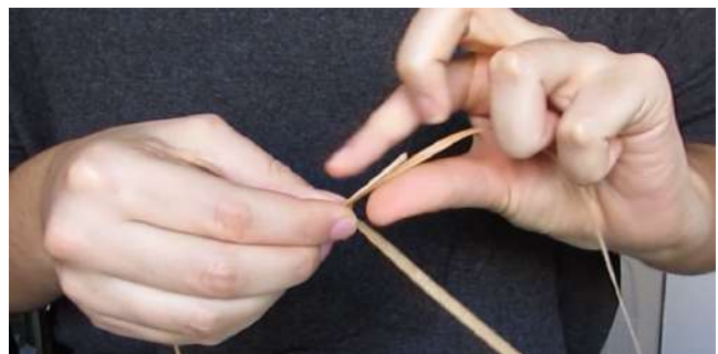
Unión tiras de totora en el hilado
