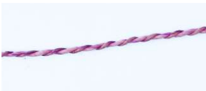
Hilado teñido con anilina al alcohol
