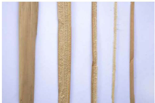
Totora en las distintas etapas de corte
