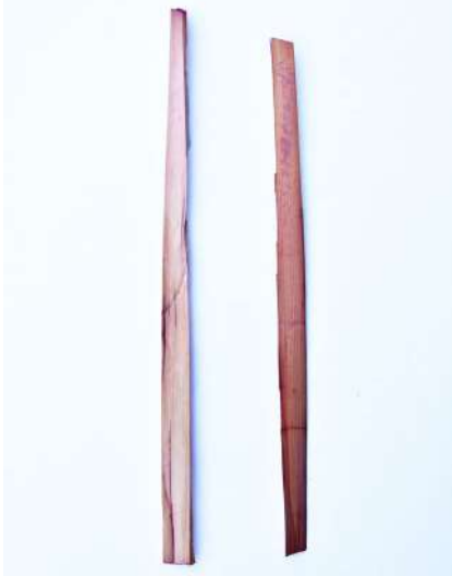
Totora entera teñida con anilina al alcohol
